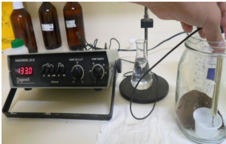
Figura 6. Respirômetro (2L) utilizado com as misturas das doses de lodo com o solo e o recipiente plástico contendo a solução de NaOH ( 0,5 \text{ mol L}^{-1} )
