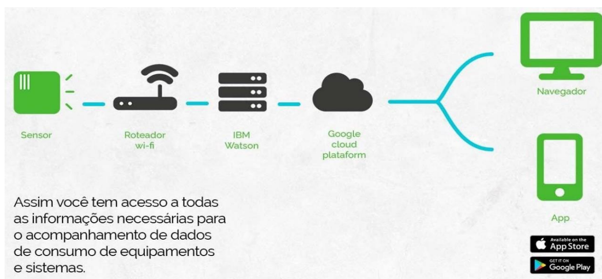
Figura 1 - Arquitetura da Utilities Control
